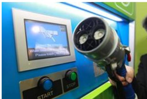
圖為快速充電器的充電插頭(右)及顯示屏。顯示屏清楚顯示快速充電器如何運作及電動車的電量，讓駕駛者一目了然。
