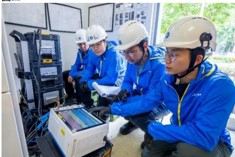
中華電力電力質量小組於比賽場館進行模擬電壓驟降測試，並為兩個比賽場館提供電力質量諮詢服務。
