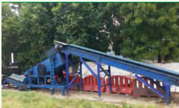
哈格爾電廠用作物料回收的震動給料機。
